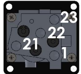
**735 - VÁLVULA NEUMÁTICA 5/2 1/8" BSP MANDO NEUMÁTICO CON REACCIÓN A RESORTE**
