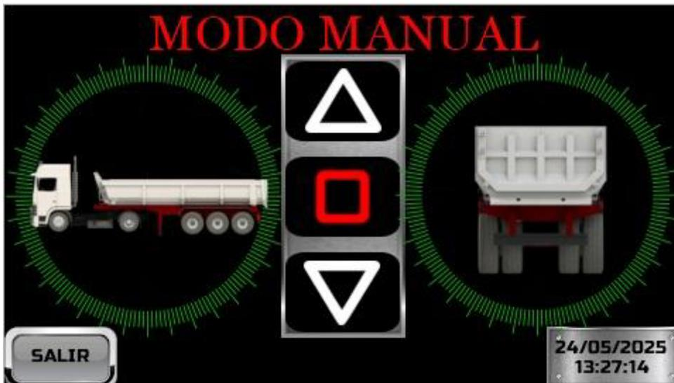
Nota: Se debe tener en cuenta que en modo manual el inclinómetro no actuará automáticamente en caso de que la inclinación supere los límites configurados.
