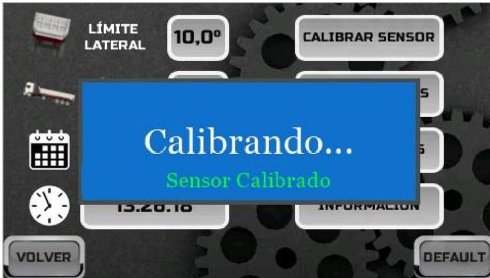
En caso de que falle, la calibración debe volver a realizarse. Antes de volver a calibrar, asegurarse de que el sensor se encuentre conectado (desde la pantalla de stand by debemos ver valores reales en los campos "Ángulos" **0,0°** y no el cartel de "Sensor desconectado" **Sensor Desconectado**). En pantalla se mostrará:
