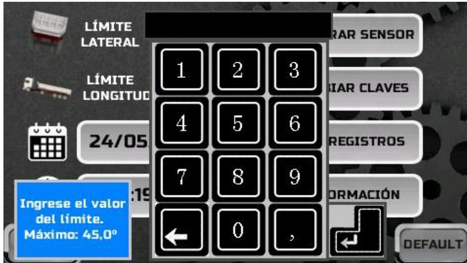
Por medio del teclado debemos introducir el valor deseado, el mismo debe estar comprendido entre 0° y 45° y con una precisión de 0,1° (por ejemplo: 2,5 o 3,0). Una vez introducido el valor deseado, para volver a la pantalla anterior, se debe
