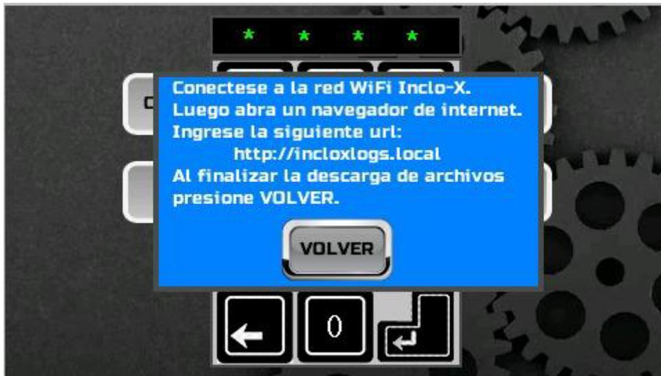
Una vez conectados al inclinómetro, a través del navegador del dispositivo (Chrome, Safari, Ópera, etc.) ingresamos a la siguiente URL: <http://incloxlogs.local>. Podemos ver los distintos logs generados.
